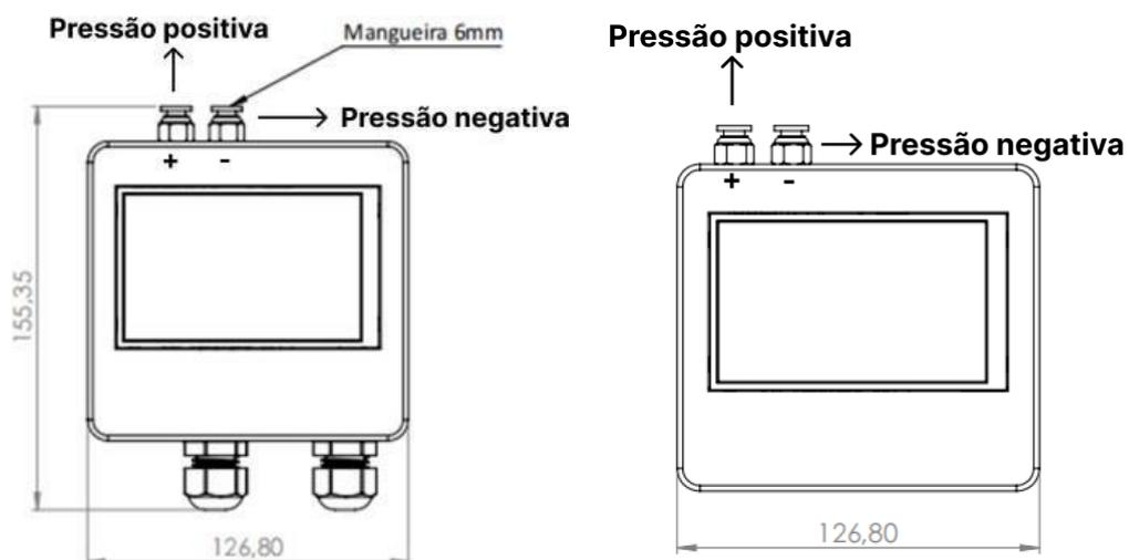
Vista frontal da caixa, prensa cabos para conexões elétricas.
